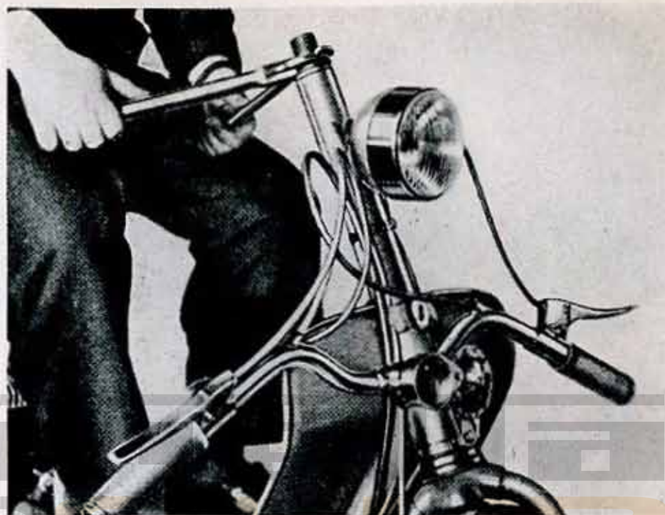
Fig. 51. — Démontage des écrous du palier supérieur de la direction.
